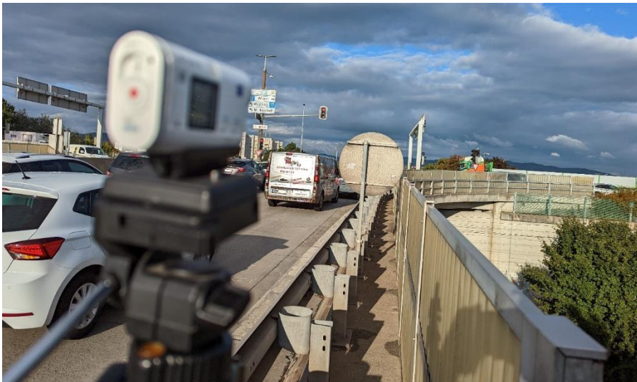
Abbildung 22: Verkehrstechnische Erhebung VLSA Phase mittels Kamera
