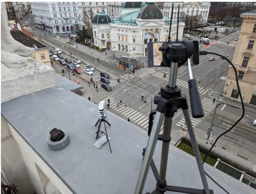
Abbildung 23: Verkehrstechnische Erhebung mittels Kamera auf einem Gebäude
